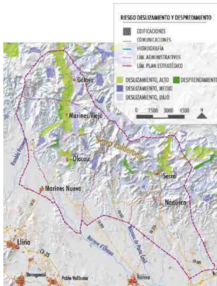
Plano 0.17.2.: Riesgo de deslizamientos y desprendimientos. (1: 220.000). Fuente: CITMA
